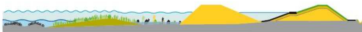
Schematische weergave van een oeverdijk. Rechts de oude dijk met asphalt (zwarte lijn) en een groene toplaag. Versteving vindt nu niet plaats door middel van verbreding en verhoging, maar door geleidelijke overgangen. Uiterst links een verharding met bijvoorbeeld schelpen. Daartussen in (pioniers)kwelders, duinen en een geulensysteem. ILLUSTRATIE: Deltaprogramma Waddengebied
