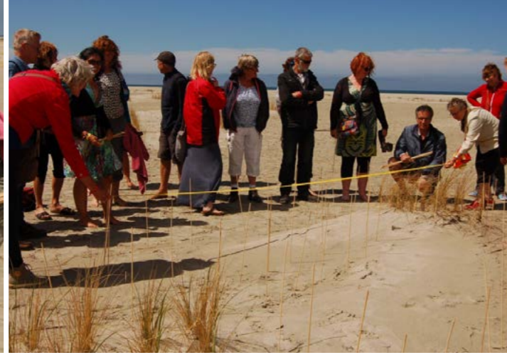
Afzetten van de duinstaarten en meten van lengte en hoogte van de duinen. Geheel rechts: meten van zoutgehalte aan de hand van de elektrische geleidbaarheid van het zand op de duinen, op het strandoppervlak en het grondwater. foto's Maria Floris
