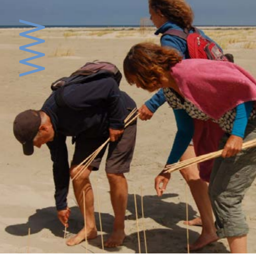
Afzetten van de duinstaarten en meten van lengte en hoogte van de duinen. Geheel rechts: meten van zoutgehalte aan de hand van de elektrische geleidbaarheid van het zand op de duinen, op het strandoppervlak en het grondwater. foto's Maria Floris
