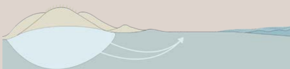
Een schematische doorsnede van duin naar zee, het zoete water uit de zoetwaterbel kwelt naar de zilte strandvlakte
