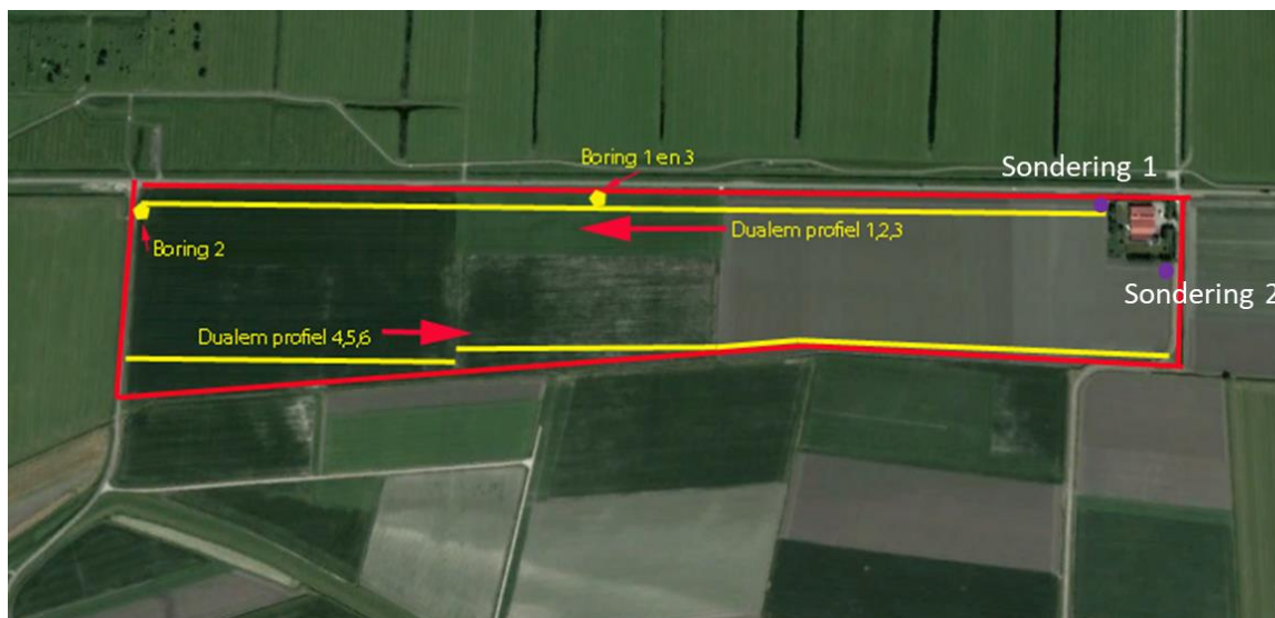
Figuur 20 Locatie van de ondiepe boringen (1 tot 3 m diep), DUALEM-profielen en sonderingen uitgevoerd in juli 2016 als voorstudie.
