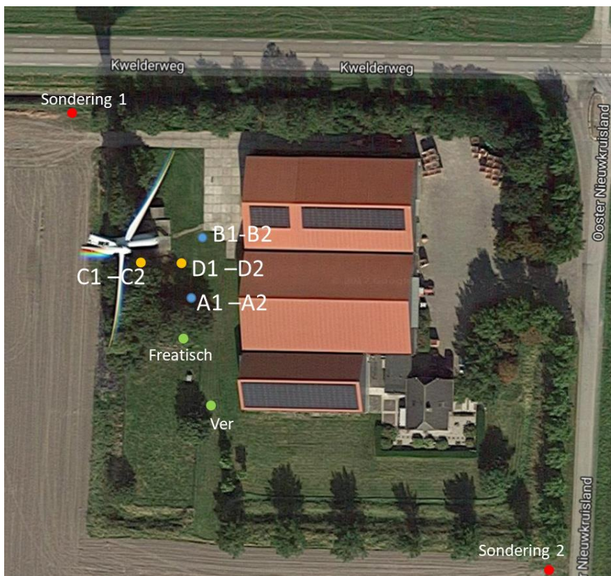
Figuur 23 Locatie van de huidige waterbronnen (A1, A2, B1, B2) en de uitbreiding daarvan (C en D). De twee freatische peilbuizen en twee diepe sonderingen zijn ook in de figuur meegenomen.
