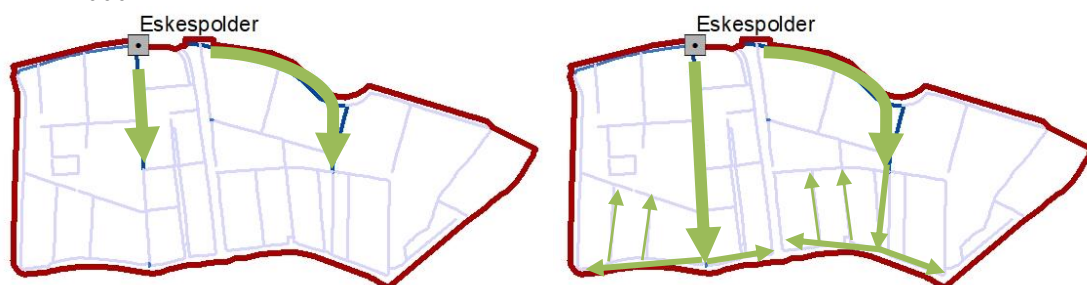
Figuur 47: Verzoetingsscenario's. Links: enkel hoofdwatergangen. Rechts: geheel oppervlaktewatersysteem.
