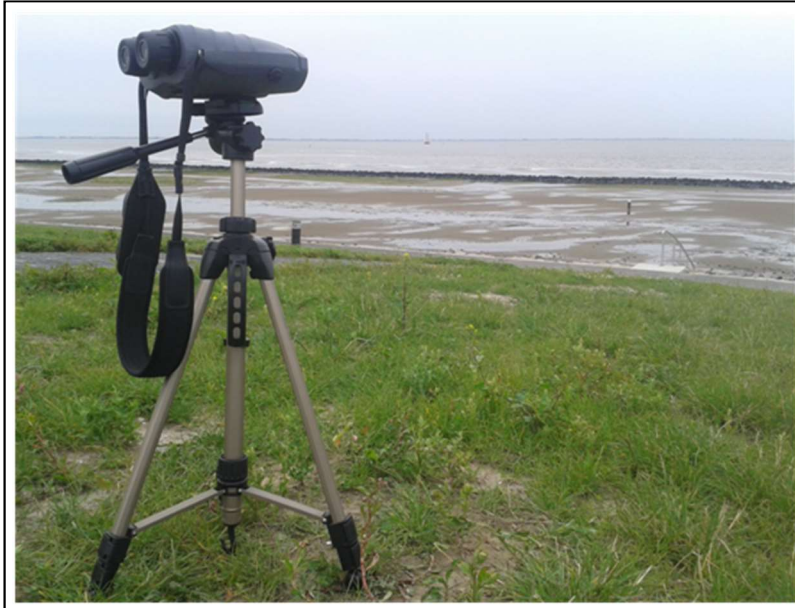
Figuur 9. De verstoringsafstand is gemeten met de Vector 21 rangefinder, een verrekijker met ingebouwde rangefinder die snel en accuraat de posities van vogels, zeehonden en verstoringsbronnen kan inmeten zonder zelf te verstoren.
