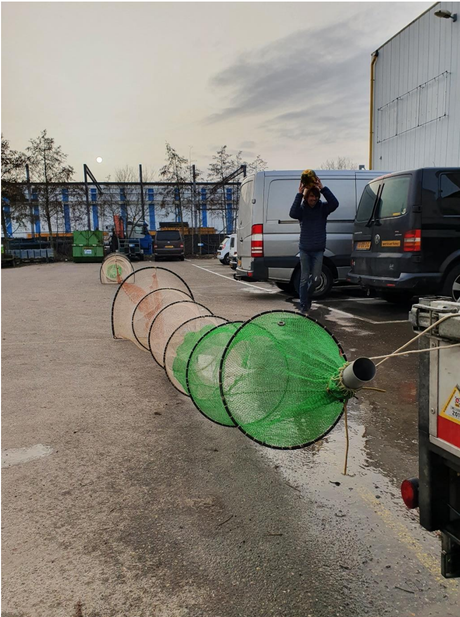
Foto 2: De schietfuij bestaat uit twee kleine fuien , elk gemonteerd aan een uiteinde van een 6 meter lang schutnet, dat de vis en garnalen naar de opening van de fuij leidt. Hier ook het PVC ontsnappingsbuisje.
