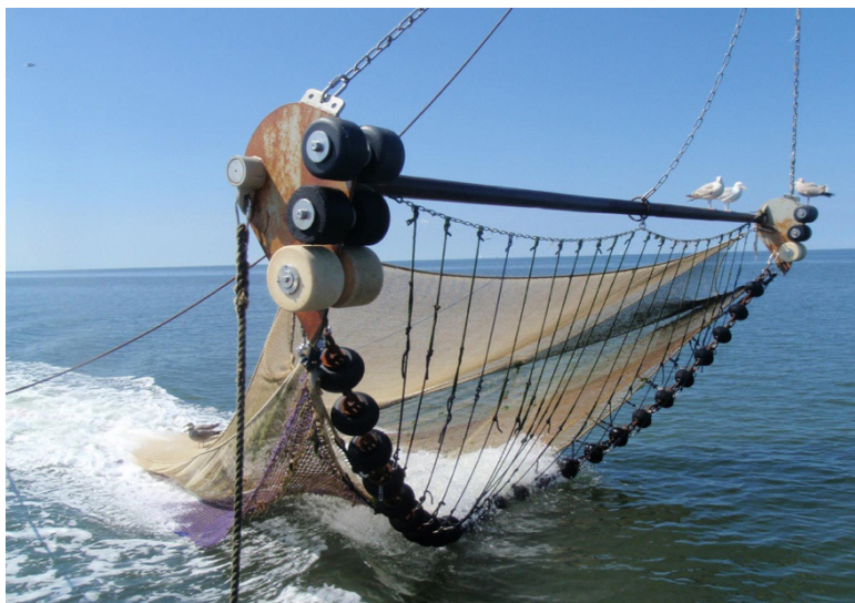
Figuur 3-13. Garnalentuig met stalen boom, die aan beide zijden door 'sloffen' wordt ondersteund, met aan de onderzijde van het net rubberen klossen die over de zeebodem rollen (foto door A. Rippen).
