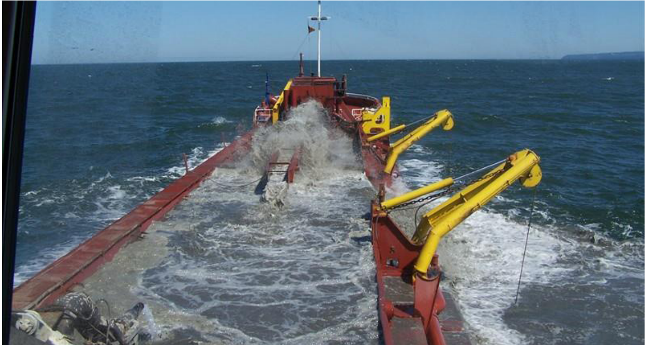
Figuur 3-15. Het schip Zeezand Express wordt gebruikt om op de Noordzee zand te zuigen dat vervolgens wordt afgeleverd bij de Spaansenvestiging in Den Helder en de zandzeverij in Harlingen (foto van marinetraffic.com).
