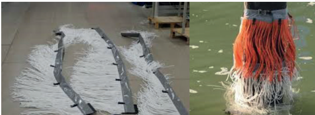
Figuur 3 Paalhula's (links) en Paalhula's rondom een meerpaal in de haven van Rotterdam (rechts)
