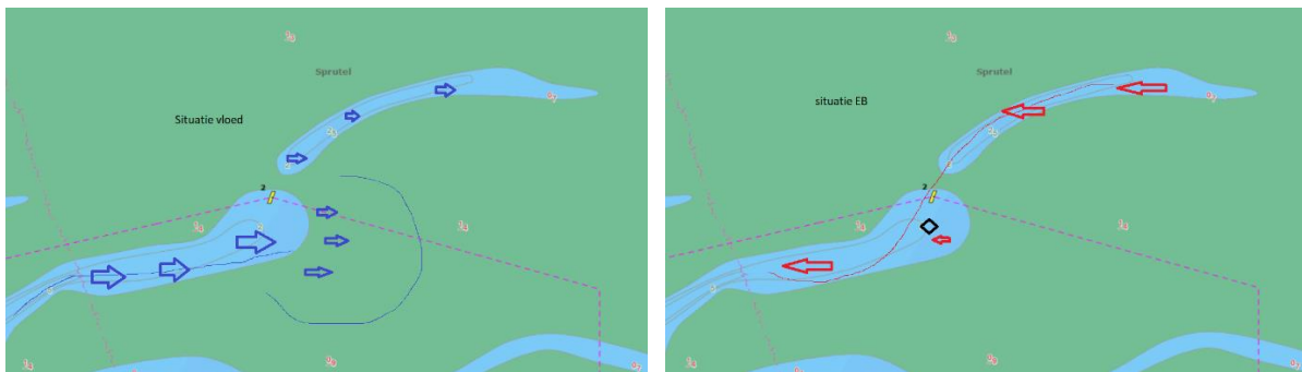
Fig.4 Stroomrichting bij vloed (links) en bij eb (rechts) op de voorkeurslocatie Sprutel, gelegen in een vloedschaar
