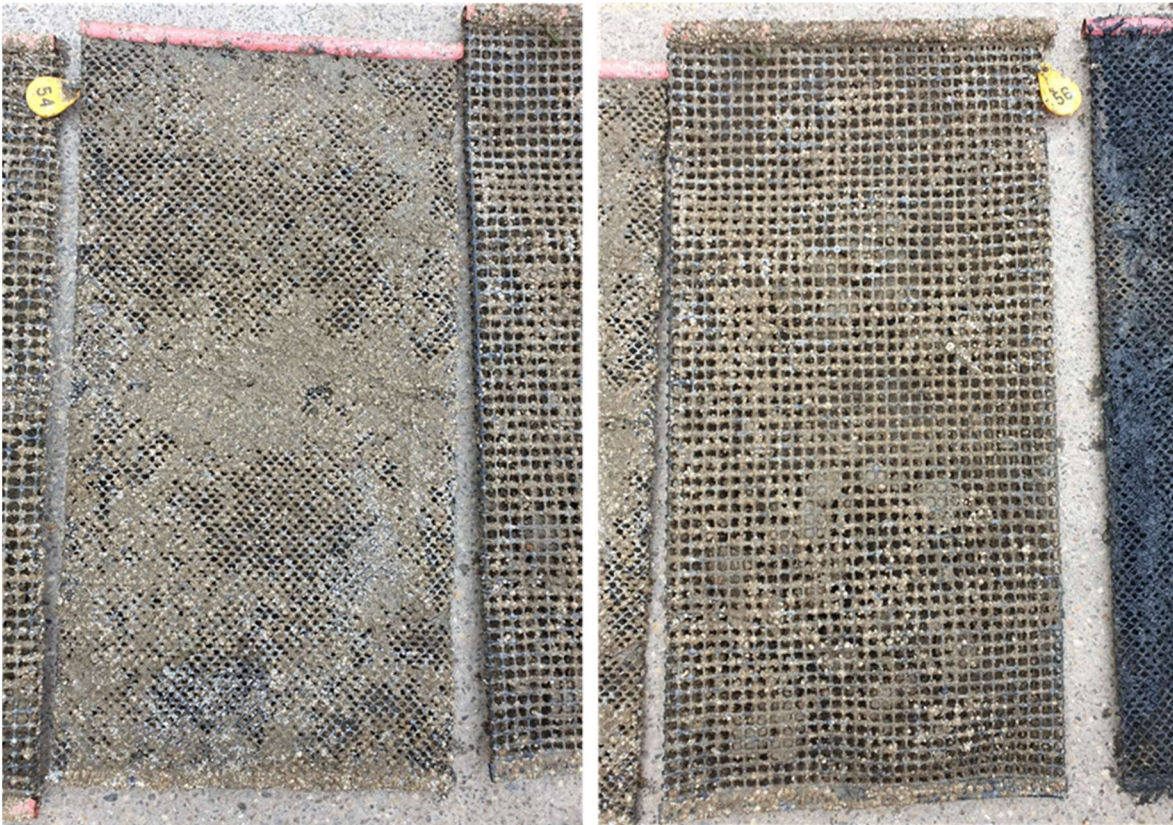
Foto 5. Aangroei op de zakken bij het uithalen op de locatie Lauwersoog; links kleine maaswijdte, rechts grote maaswijdte.
