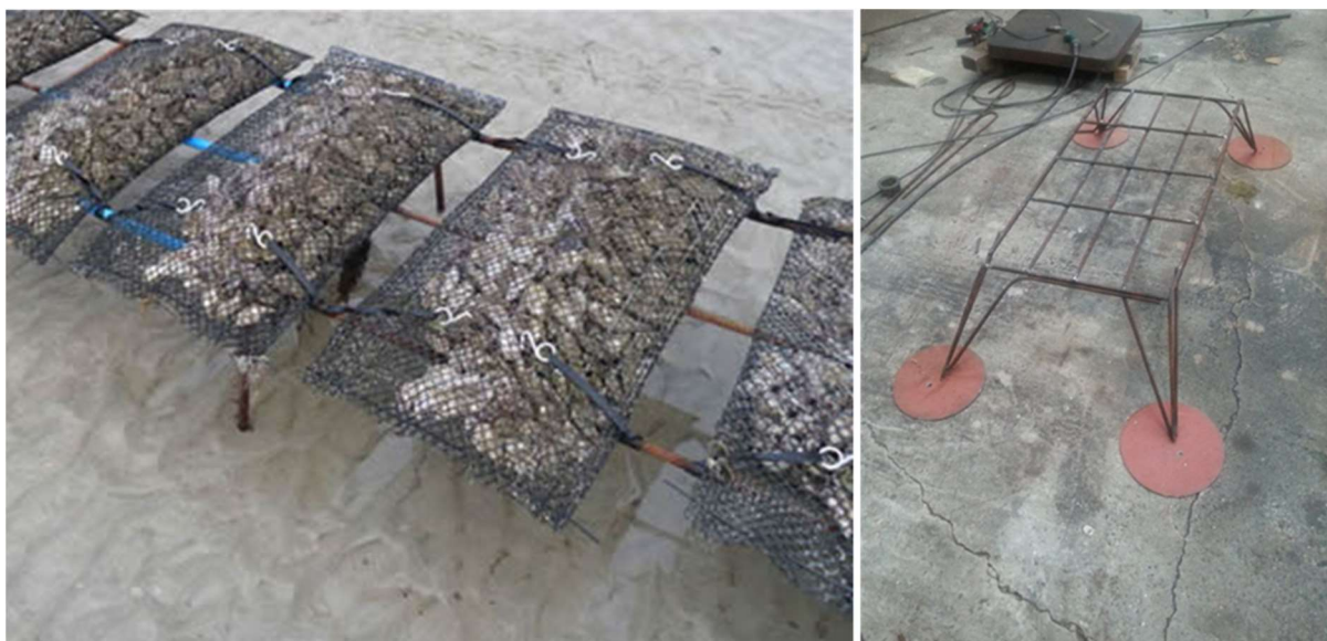
Foto 1. Links: In oesterkweek gebruikte opstelling met HDPE oesterzakken (bron: www.intermas.com ). Rechts: Test-frame voor het ophangen van de oesterzakken.
