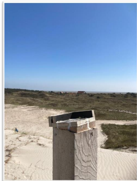
Figuur 4 - Verschillende vormen van monitoring; voor de hoeveelheid ingestoven zand (links) en voor de morfologische ontwikkeling (rechts)
