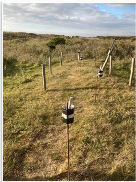
Figuur 4 - Verschillende vormen van monitoring; voor de hoeveelheid ingestoven zand (links) en voor de morfologische ontwikkeling (rechts)
