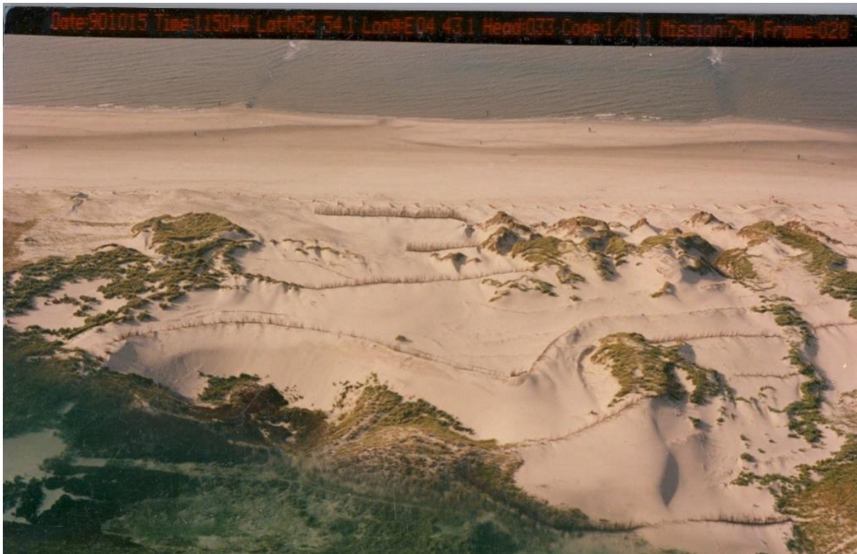
Figuur 58. Rollende zeereep bij de Zandloper, 15 oktober 1990. Op de zeereep is een groot aantal kerven in zuidwestelijke richting gegraven. Op boven- en achterzijde (midden en onderaan de foto) zijn de stuifschermen zichtbaar die het zand gecontroleerd invangen, om een gesloten duinenrij te garanderen (Foto Rijkswaterstaat).
